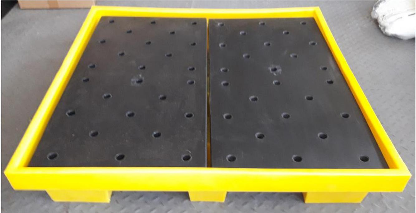
Pallet antiderrame de PVC para 4 tambores, con bandeja plástica embutible para retención de líquidos. Capacidad 210 L. Apto para ser movido con carga. Entrada para zorra o autoelevador por 2 lados. Paneles superiores desmontables.
